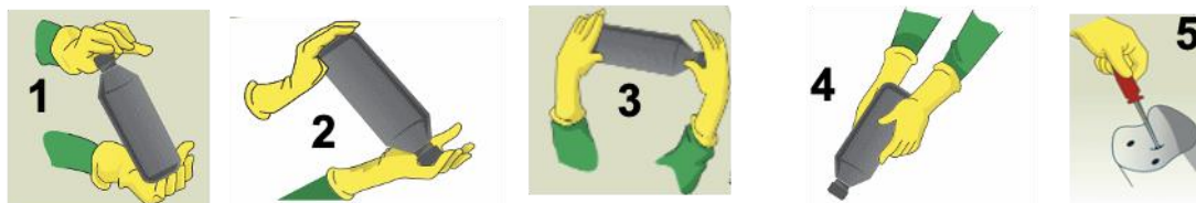
Figura 4. Procedimiento para realizar el triple lavado de envases vacíos.
