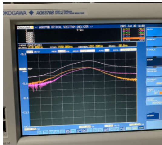
Figura 6. Espectro de salida de un acoplador 50/50
