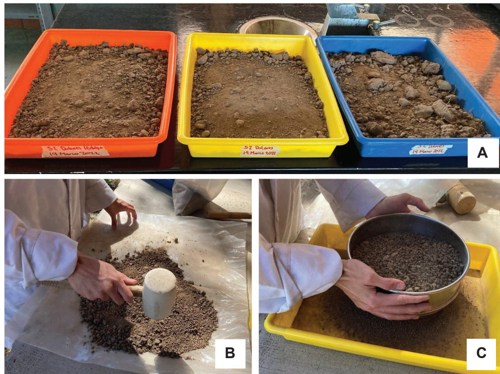
Figura 19. Procedimiento de preparación de las muestras de suelo. (A) Secado, (B) molienda y (C) tamizado.
