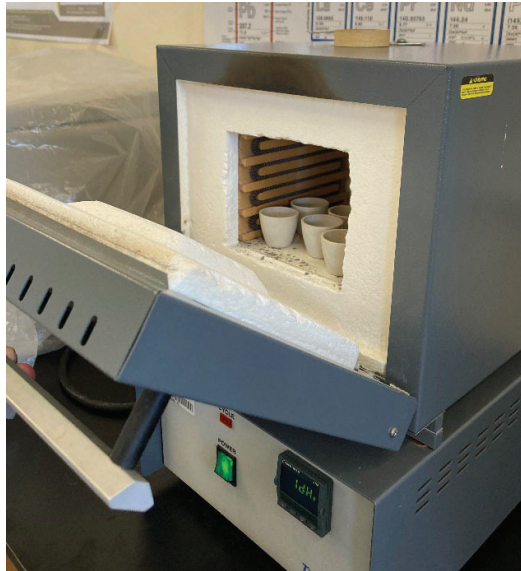
Figura 25. Crisoles con las muestras de suelo en la mufla para PPI.
