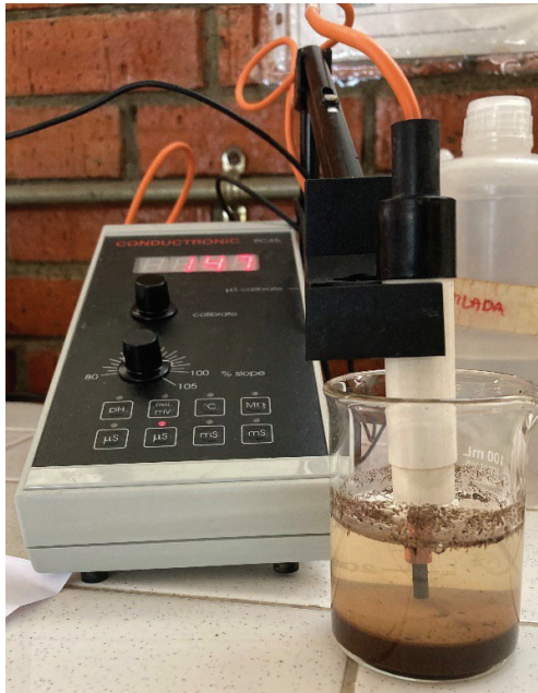
Figura 22. Medición de CE en las muestras de suelo estudiadas.
