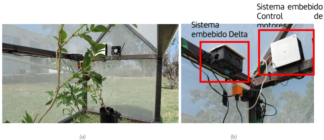
Figura 8. Estructura interna del invernadero (a) Interior del invernadero inteligente. (b) Ubicación de sistemas embebidos
