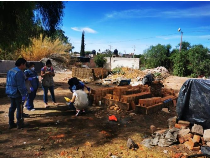
Figura 3. Zona en donde se observan ladrillos ya cocidos y otros en proceso de secado (al fondo)
