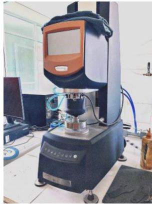
Figura 10: Reómetro de corte dinámico, Discovery, modelo HR10 (tomado de VISE, planta León Gto)
