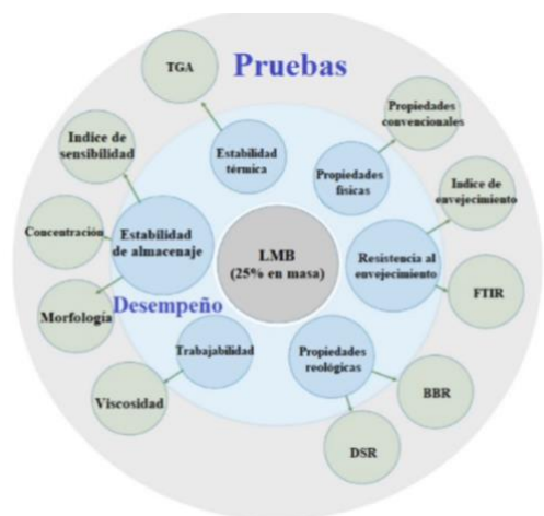
Figura 8: Propuesta de pruebas para la mezcla lignina- asfalto. (Wu et al., 2021b)
