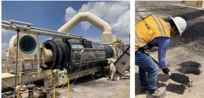
Figura 9: Tambor mezclador Astec Double Barrel® (izquierda). Muestra de asfalto en suelo (derecha). (tomado de VISE planta León, Gto.
