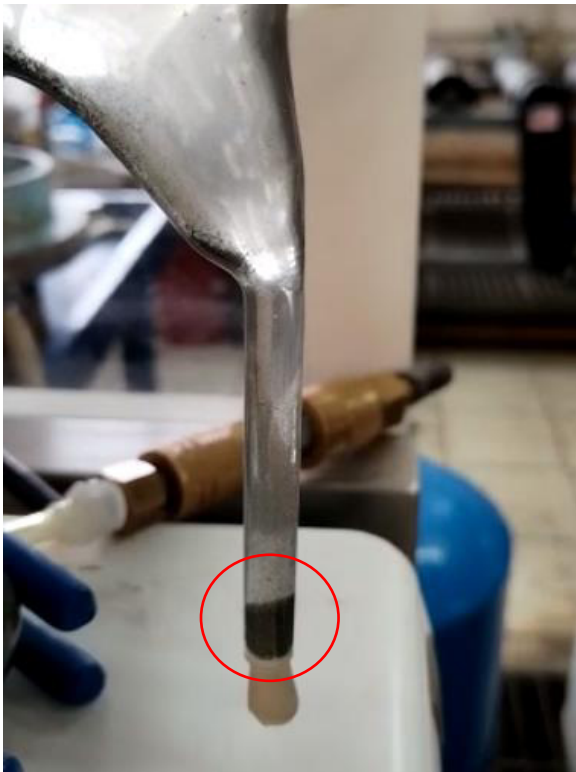
Figura 31. Concentrado mineral en tubo Hallimons durante microflotación.
