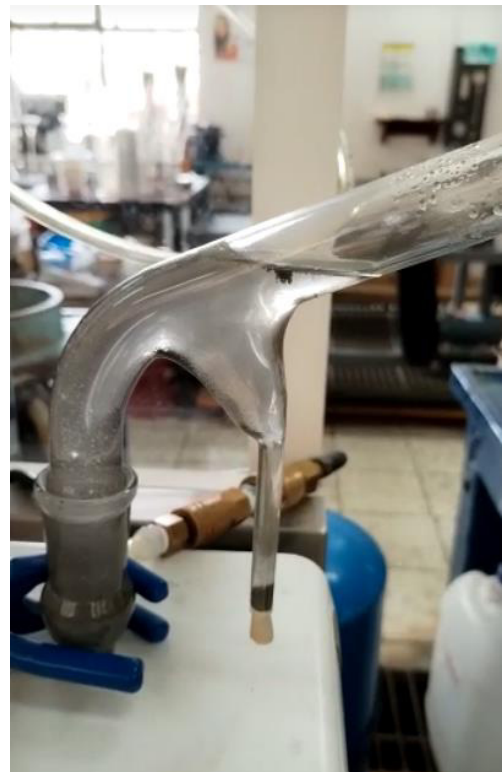
Figura 32. Flotación en tubo Hallimond.
