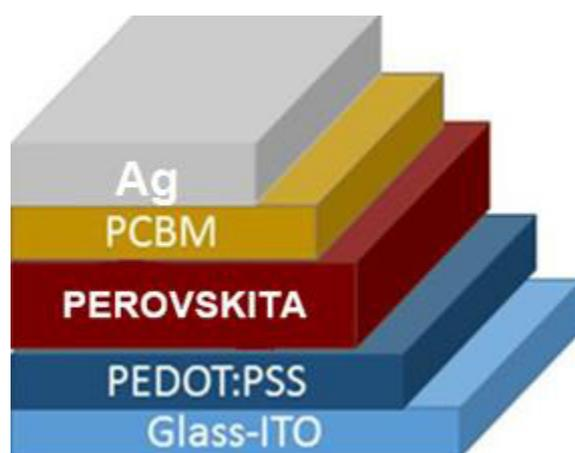
**Figura 21.** Estructura de la celda fotovoltaica de perovskita invertida.
