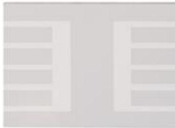
**Figura 20. Vidrio con depósitos de ITO.**
