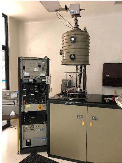
**Figura 23. Evaporadora de metal Balzer ba510.**
