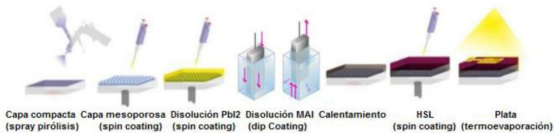
**Figura 18. Esquema general de fabricación de un dispositivo fotovoltaico de CH<sub>3</sub>NH<sub>3</sub>PbI<sub>3</sub>.**
