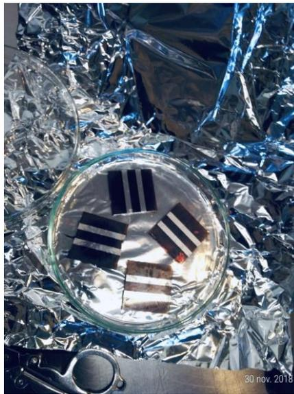
**Figura 30. Celdas de perovskita invertida**
