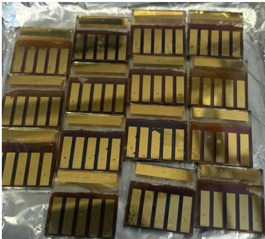
**Figura 5.12. Batch de celdas fabricadas con estructura ITO/SnO<sub>2</sub>/QDs  $\text{Cs}_{0.1}\text{FA}_{0.9}\text{PbI}_3$ /Spiro-OMETAD/Au.**
