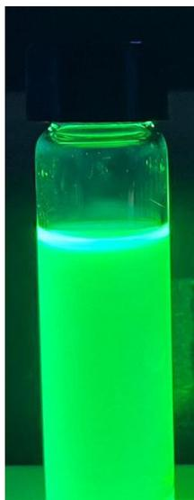
**Figura 5.19. Puntos cuánticos de CsPbBr<sub>3</sub> sintetizados por ultrasonido dispersos en hexano.**
